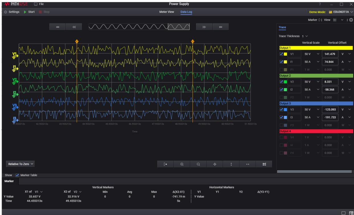
图 3. 使用个人电脑上的 PathWave Benchvue 软件记录数据
