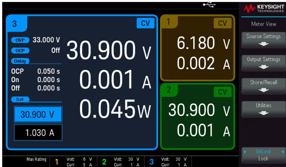
图 2. 查看单个通道的详细信息，包括测得的功率、OVP/OCP 条件和时延。
