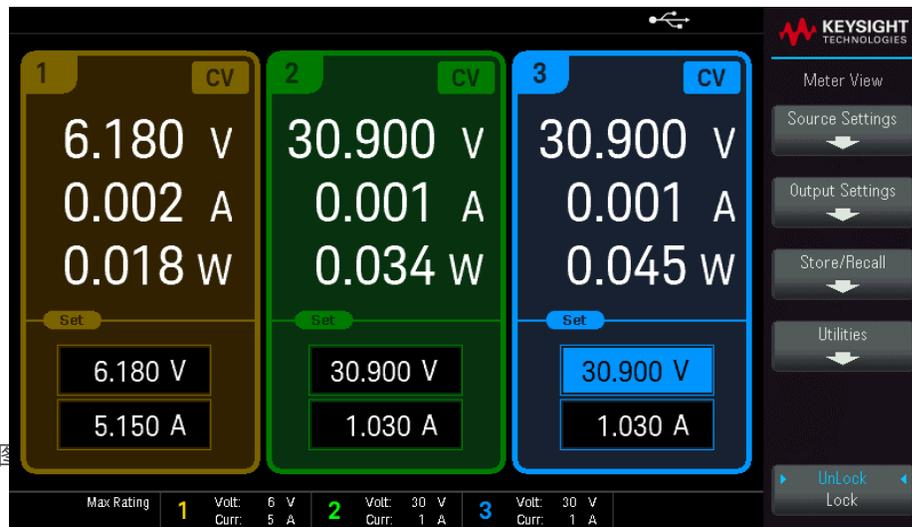
图 2 是单通道视图，其中包括测得的功率、设置的 OVP/OCP 条件和时延。您还可以监视其他两个通道的回读、电压和电流。
