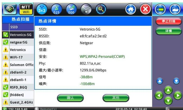
相邻信道的测试结果可以按照不同的方式进行排序, 包括占用百分比, 热点数量, 同信道热点的数量以及最强的信号, 这些参数对于工程技术人员验证高信道占用率等影响问题非常重要, 这时候必须快速决定是否重新配置热点到一个新的信道。
