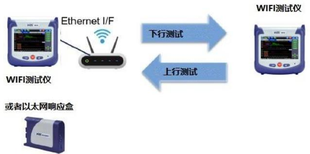
用户经常抱怨的问题通常可以归为一个“网络慢”的问题，WIFI 测试仪的 V-Perf 测试功能有助于证明 WIFI 网络情况的好坏，可置的数据发送速率和通过/失败门限，工程技术人员可以快速的辨别运行的上行和下行速率是否满足 SLA 的要求，特别是一些高带宽的业务，像音频和视频数据流业务。
